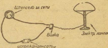
ру должен быть включен предохранитель на силу тока в 0,25 амп. Подобный конденсатор с предохранителем, соединенные вместе, выпускаются трестом «Электросвязь» в виде специальной штекельной вилки. Вилка снабжена с одной стороны двумя ножками (из которых одна холостая) для вставления в
