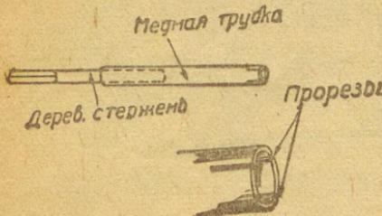
Рис. 2. Медная трубка, применяемая для сверления.
